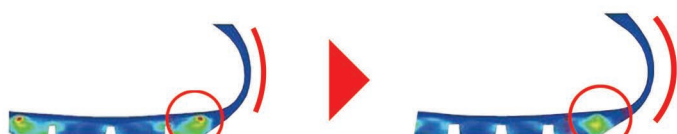
Ulepszony rozkład ciśnienia, zapewniający niskie opory toczenia.
