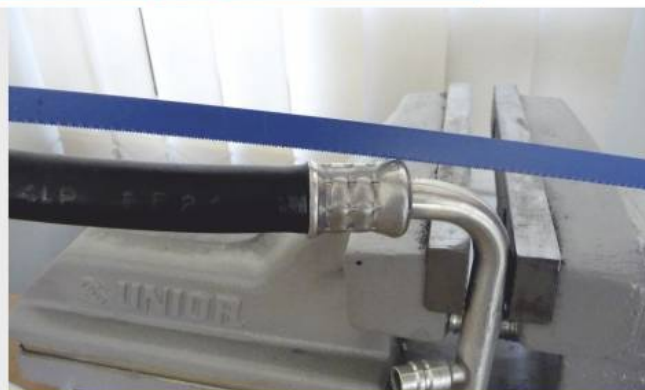
Fot-11 Cienką piłą należy rozciąć zacisk fabryczny i zdjąć uszkodzony przewód gumowy.
