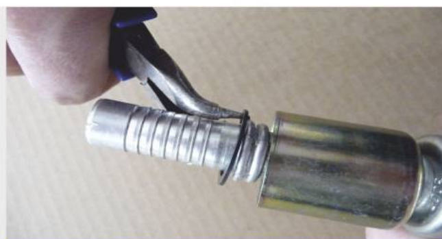
Fot-15 W rowek między spęczeniami wkładamy pierścień sprężysty, który zablokuje kielich zacisku naprawczego przed zsunięciem się przewodu gumowego.
