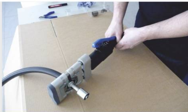
Fot-7 Prawidłowe zagniecenie kielicha zacisku naprawczego następuje gdy szczęki z „kamieniami” zostaną całkowicie zamknięte.
