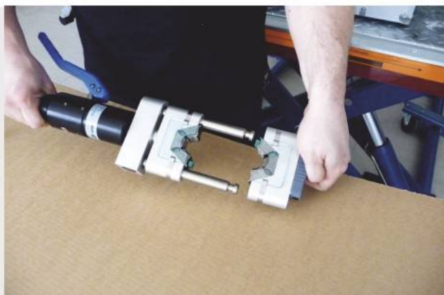
Fot-9 Głowica zaciskarki składa się z dwóch rozłącznych części. Pozwala to na łatwą zmianę szczęk zaciskowych lub na wyjęcie narzędzia po zaciśnięciu zacisków na zamocowanym przewodzie w pojeździe.
