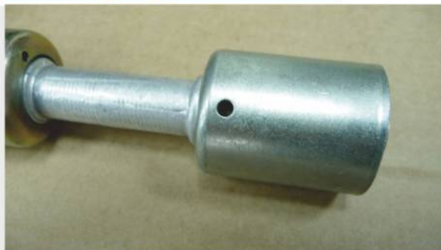
Fot-5 Otwór rewizyjny w kielichu zacisku naprawczego. W otworze tym powinno się widzieć krawędź wsuniętego przewodu gumowego.
