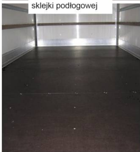
Gotowe zastosowanie sklejki podłogowej
