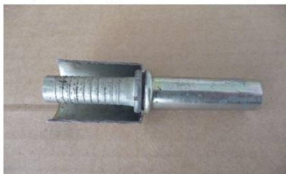
Fot-12 Zacisk fabryczny po rozcięciu. Widoczne spęcenia wykorzystywane są do mocowania kielicha zacisku do końcówki, co zapobiega zsunięciu się jego wraz z przewodem elastycznym.
