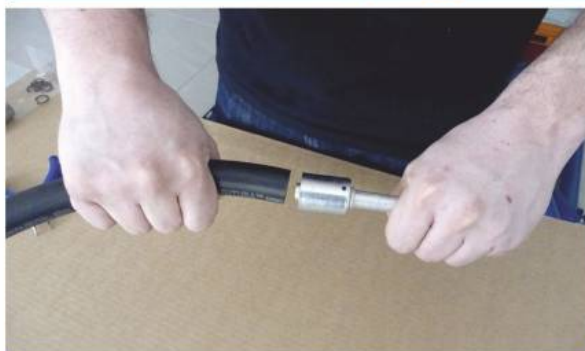
Fot-4 Przewód gumowy należy wsunąć do zacisku splitera.
