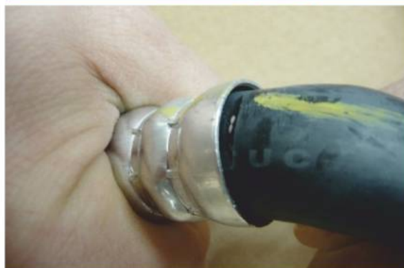
Fot-10 Uszkodzenie w pobliżu fabrycznego zacisku kwalifikuje cały przewód gumowy do wymiany.
