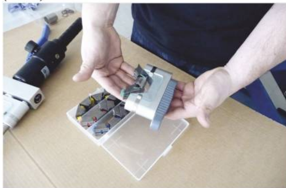
Fot-6 W głowicy zaciskarki montuje się „kamienie”. Szczęki mocowane są do głowicy za pomocą małego magnesu.
