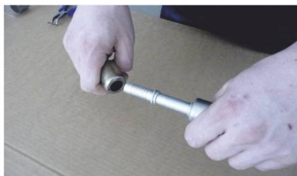
Fot-14 Rozwierzony otwór w kielichu zacisku naprawczego pozwala przesunąć nowy zacisk za spęcenia na fabrycznej końcówce.
