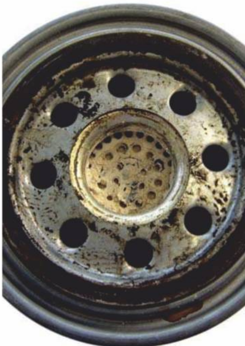
Rys. 1 Wysyp granulatu we wkładzie osuszacza powietrza
