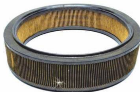
Rys. 3a Bardzo zabrudzony filtr powietrza, konieczna wymiana
