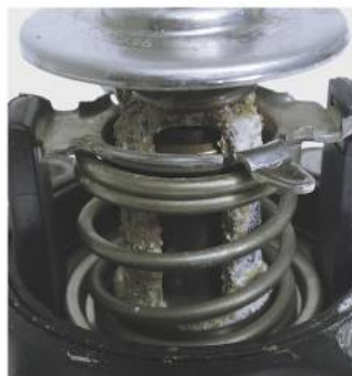
Ilustracja 2: Niezatwierdzone dodatki do czynnika chłodniczego powodują rozkład aluminium.
