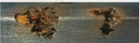
W przekroju jeszcze wyraźniej widać typowe uszkodzenie wskutek kawitacji: wżery powiększające się do wewnątrz.
