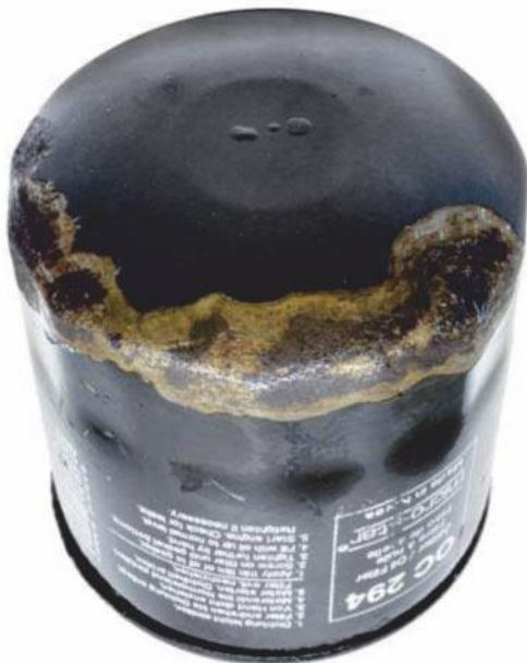
Rys. 4 Uszkodzona warstwa – skutek: korozja
