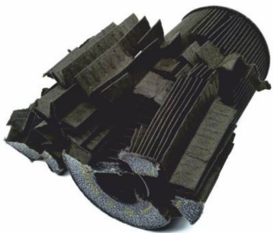
Rys. 1 Rozłożony papier filtrujący wkładu filtra olejowego
