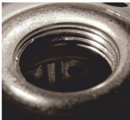
Rys. 5 Uszkodzone zwoje gwintu na skutek skośnego wkręcania filtra
