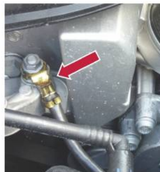
Ilustracja 3: Przewód uziemiający należy sprawdzić pod kątem prawidłowego osadzenia i uszkodzeń.
