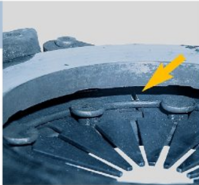
Pęknięta sprężyna talerzowa
