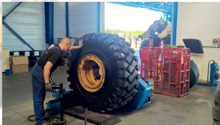
Montaż opon o wadze 600 kg w OPOLTRANS
