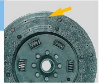
Całkowicie zużyta okładzina
