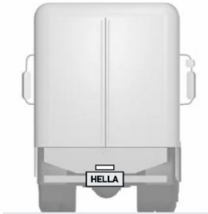
Lampa podświetlenia tablicy rejestracyjnej ECE-R48 § 6.8 i ECE-R4
