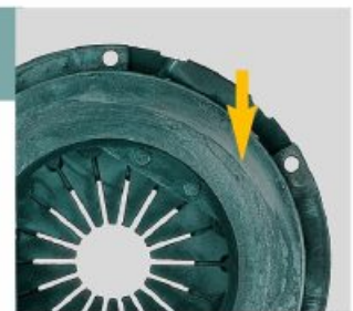
Przegrzany docisk sprzęgła
