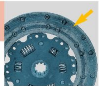
Okładzina nie przylegająca na całej powierzchni
