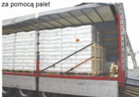
Rysunek: Mocowanie szpringowe za pomocą palet
