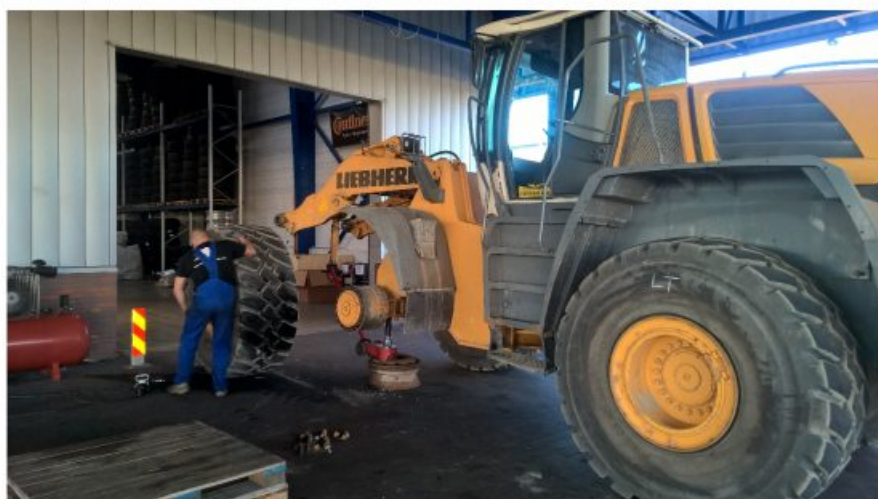
Montaż opon o wadze 600 kg w OPOLTRANS
