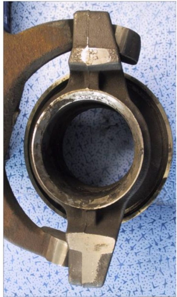
Nieprawidłowy montaż widełek wyłączających w Iveco
