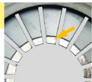
Zużycie końcówek sprężyny talerzowej
