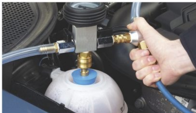
Ilustracja 3. Za sprawą efektu Venturiego w układzie powstaje podciśnienie.
