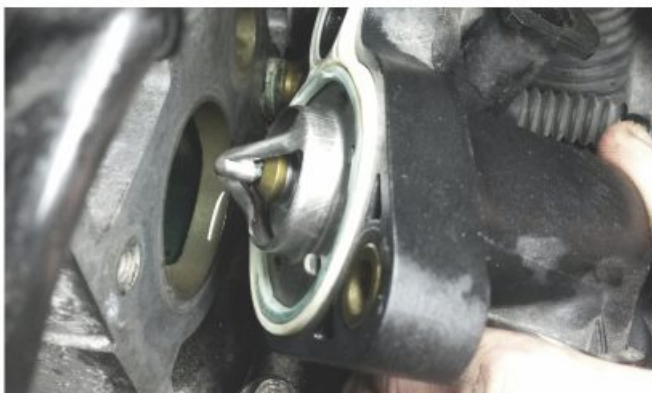
Ilustracja 1. Otwarcie obiegu chłodniczego sprawia, że wypływa z niego woda chłodząca i wlatuje do niego powietrze.
