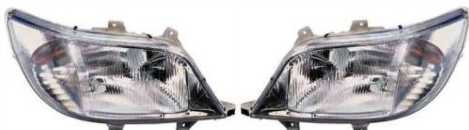
MB Sprinter 2000r.- 2002r. reflektor z regulacją, z kierunkowskazem i ze światłem przeciwmgłowym, Hella Indeks: 13-01-01-0451 (Prawy) Indeks: 13-01-01-0444 (Lewy)
