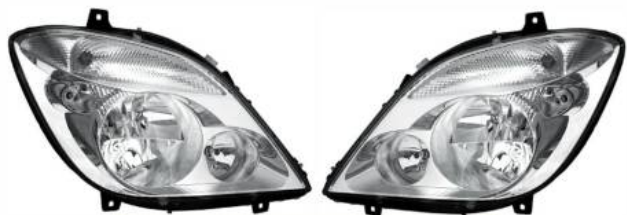
MB Sprinter 2006r.- reflektor z silnikiem reg., Hella Indeks: 13-01-01-0464 (Prawy) Indeks: 13-01-01-0463 (Lewy)
