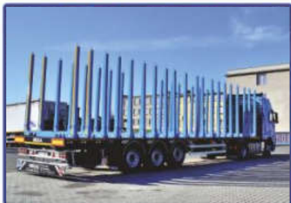
Naczepa kłonicowa - do przewozu drewna
