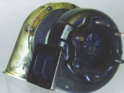
Znacznie zaolejona turbina napędzana spalinami z dużymi nagarami.
