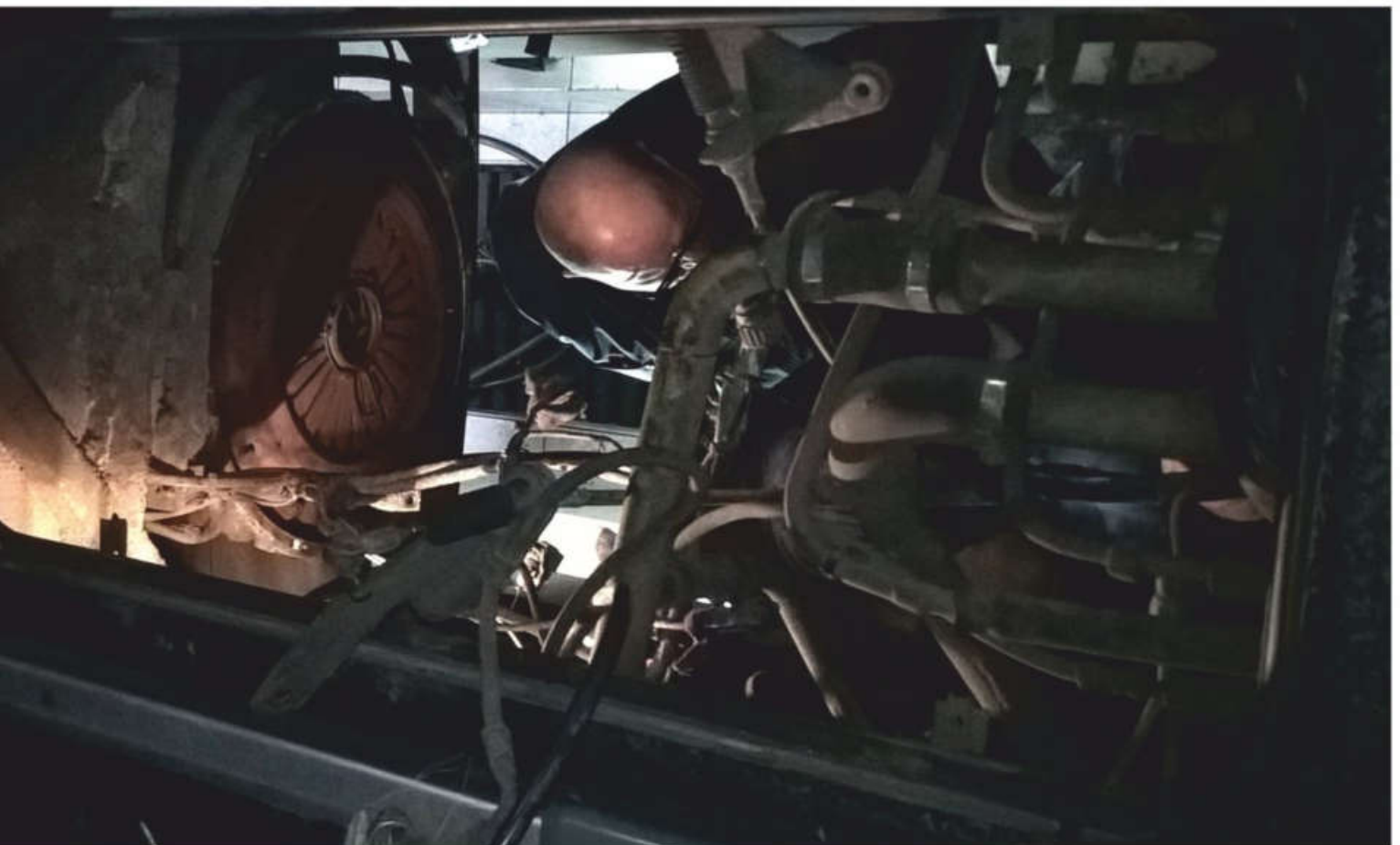
fot. 1 Odsunięta skrzynia biegów, sprzęgło przykręcone do koła zamachowego
