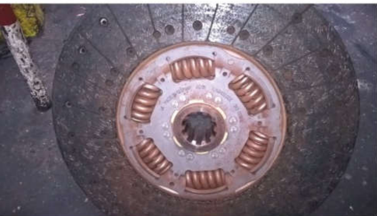
fot. 9 Tarcza sprzęgła z tłumikiem drgań skrętnych
