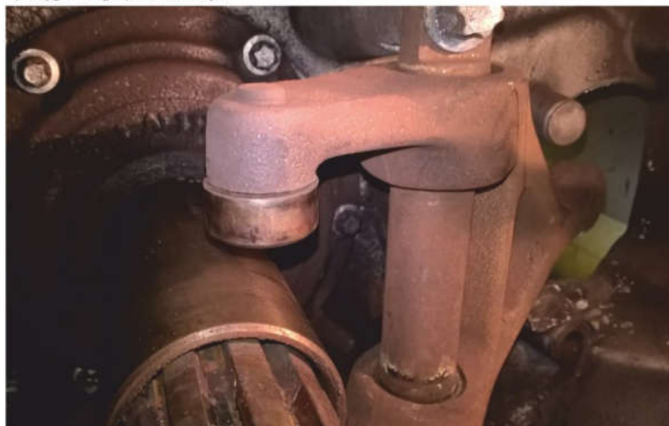
fot. 4 Dźwignia sprzęgła (łapa) i tuleja prowadząca łożyska oporowego
