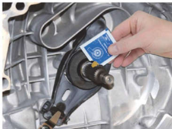
Rys. 2: Lekko nasmarować dookoła profil piasty wału wejściowego przekładni
