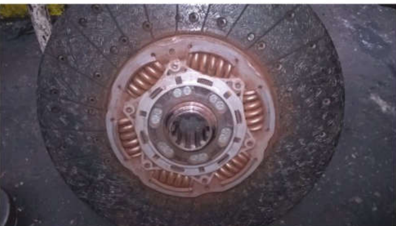
fot. 8 Tarcza sprzęgła z tłumikiem drgań skrętnych
