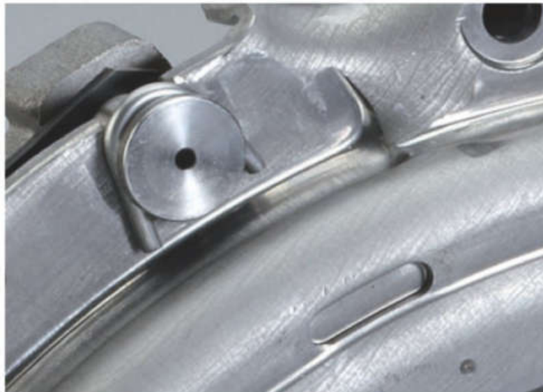
fot. 10 Zabezpieczenie transportowe - przy nitach znajdują się zabezpieczenia wykonane z drutu, które demontujemy po przykręceniu docisku
