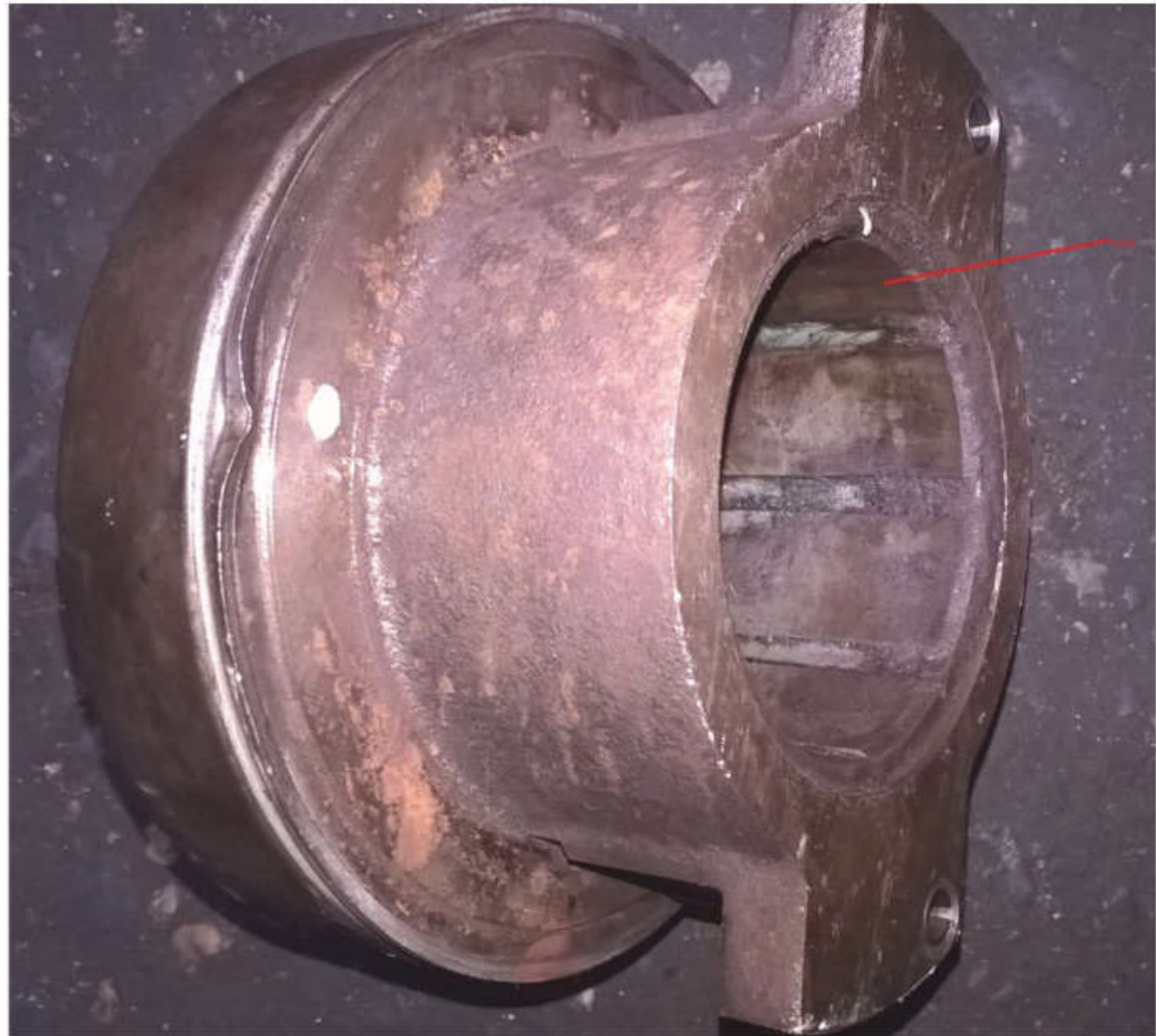
fot. 6 Łożysko oporowe, tuleja wewnętrzna łożyska z tworzywa sztucznego
