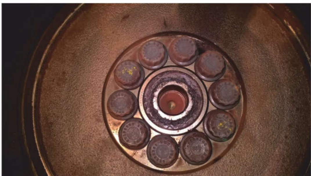
fot. 3 Łożysko podporowe (pilotujące) wałka sprzęgłowego
