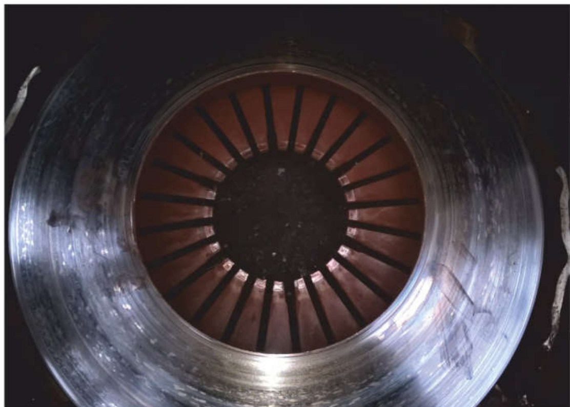
fot. 7 Docisk sprzęgła - powierzchnia płyty dociskowej i końcówki sprężyny talerzowej
