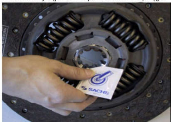
Rys. 1: Lekko nasmarować dookoła profil piasty tarczy sprzęgła
