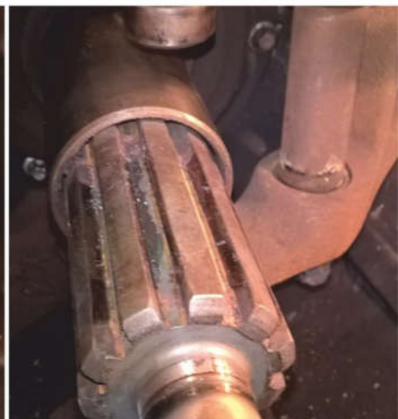
fot. 5 Kliny wielowypustu wałka sprzęgłowego
