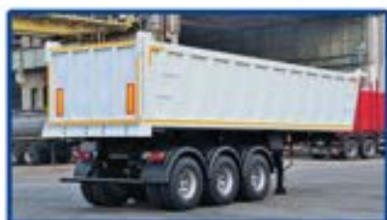
Naczepa wywrotka stalowa ciężka - DMC, 60 ton, zawieszenie mechaniczne, ogumienie bliźniacze, stabilizator wywrotu
