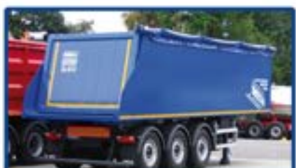
Naczepa wywrotka aluminiowa - kłapa ze zsytem - KZZ
