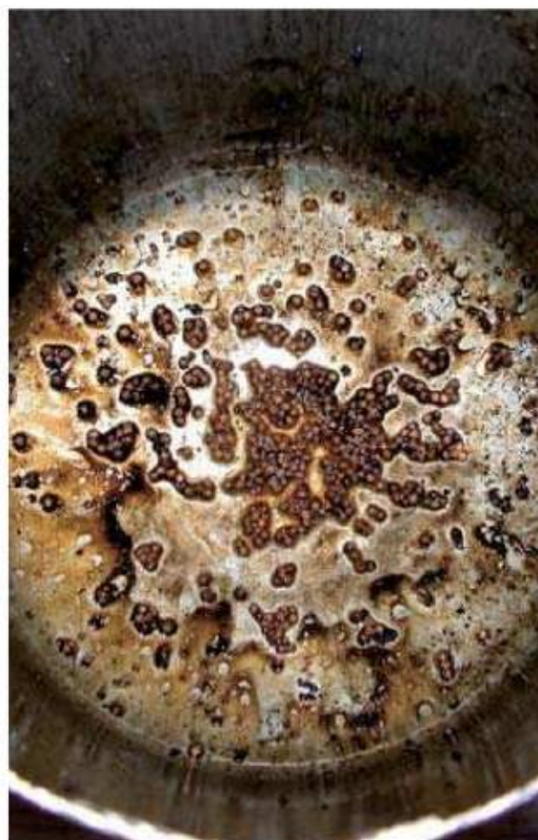
Rys. 3 Granulat, woda i olej we wkładzie osuszacza powietrza
