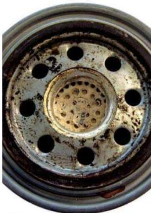
Rys. 1 Wysyp granulatu we wkładzie osuszacza powietrza
