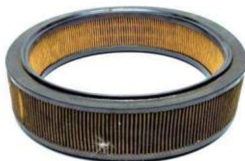
Rys. 3a Bardzo zabrudzony filtr powietrza, konieczna wymiana
