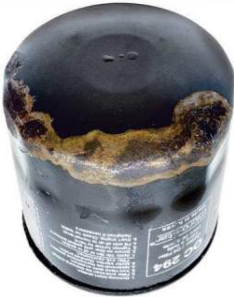
Rys. 4 Uszkodzona warstwa – skutek: korozja
