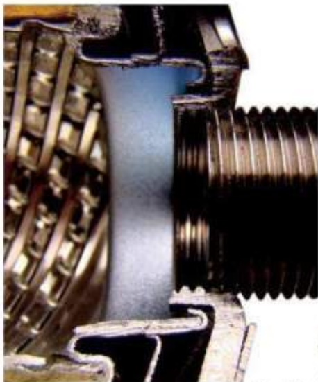
Rys. 2 Zbyt krótka końcówka gwintu przez odkręconą nakrętkę kontrolującą
